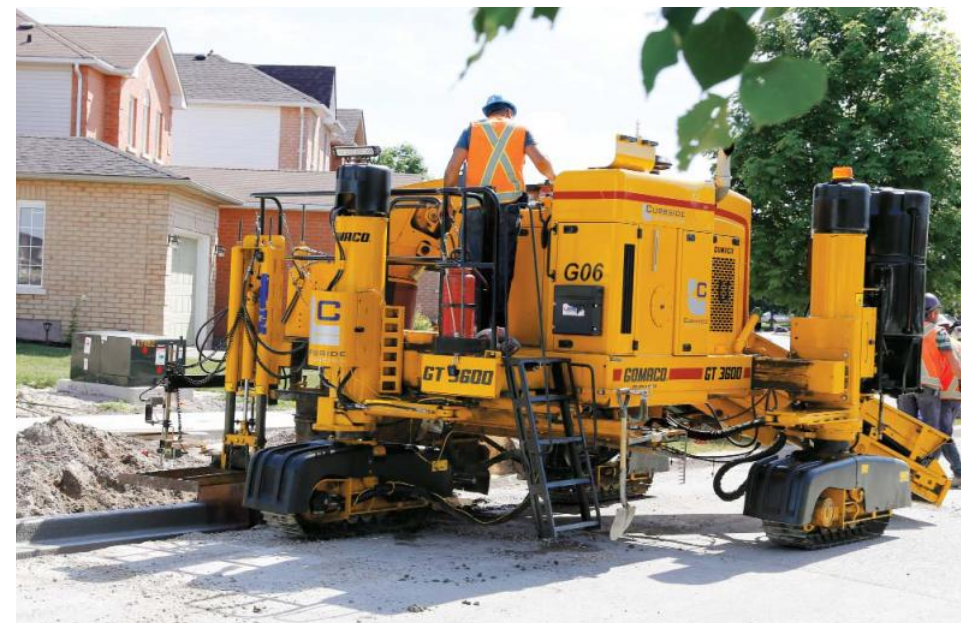
伸縮式モールドとホールドダウンを使い、既存のグレードより下でカーブアンドガッターの打設を行う際、最小限のクリアランスを実現します。
