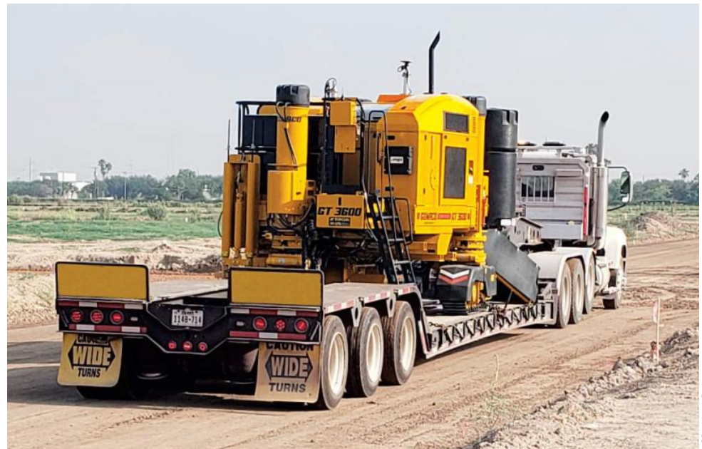
エクストリームGT-3600カーブアンドガッターマシンは容易に回送できるように設計されており、真っ直ぐにトレーラーの上に乗ることができます。
