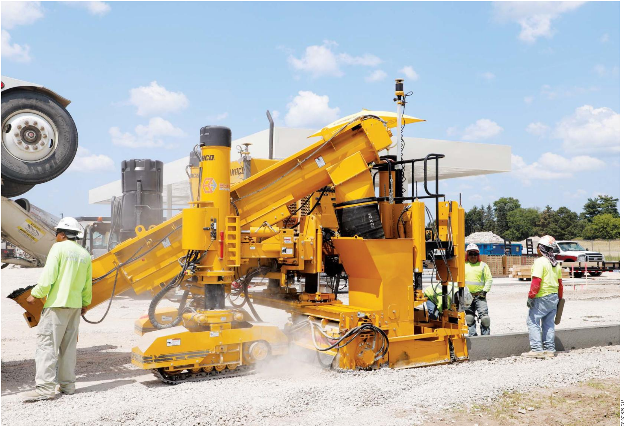
このパワフルなトリマーヘッドには、ダイレクトドライブ式のラジアルピストン油圧モーターが搭載されており、過酷なトリミング作業でも最大のトルクを発揮します。
