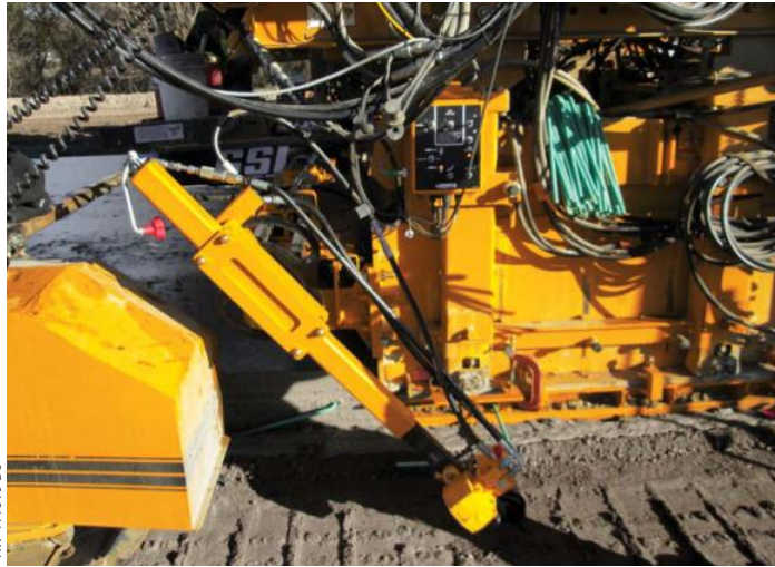
4トラックペーパーの油圧駆動式バーインサーターは、モールドの端、リアレッグの前にあります。
