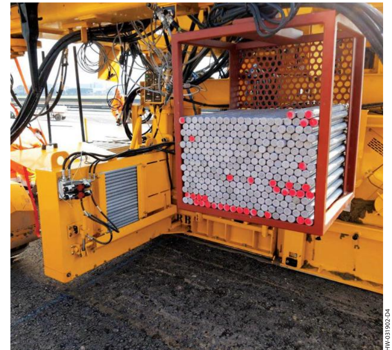
油圧式のマガジン式サイドバーインサーターを使用すると、作業員は複数のバーをマガジクリップに装填することができます。その後、このバーインサーターは1本のバーを放出し、指定された位置に配置します。
