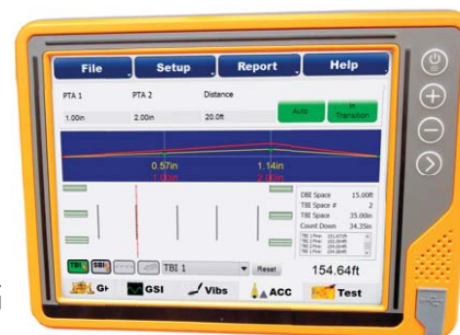
ACC(アクセサリ)画面は、何本のPTA、TBI、SBIがペーパーにセットされているかと、各距離を示しています。
