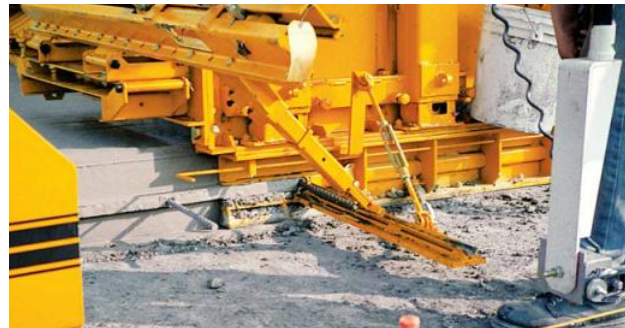
4トラックペーパーの油圧駆動式バーインサーターは、モールドの端、リアレッグの前にあります。
