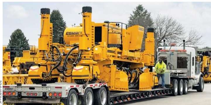
4トラックGP-2400は、オプションのロータリーセンサー付きスルードライブを特徴としています。
