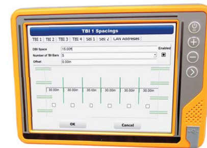
作業員は、TBI/SBIの設定メニューで、各水平目地間の必要なバーの本数を入力します。これにより、ナビゲーターが各バーと水平目地との間隔を計算し、バーの配置管理をシンプルかつ簡単に行えるようになります。
