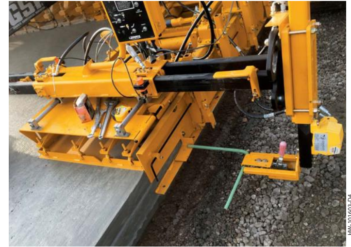
2トラック油圧バーインサーターは、モールドとトラックの後ろを追います。
