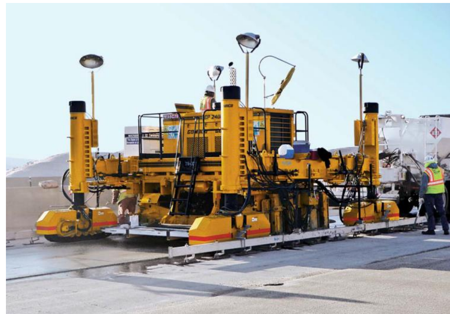
GP-2400が、新しい橋梁に0.75インチ(19mm)の厚さのポリマーオーバーレイを打設しています。
