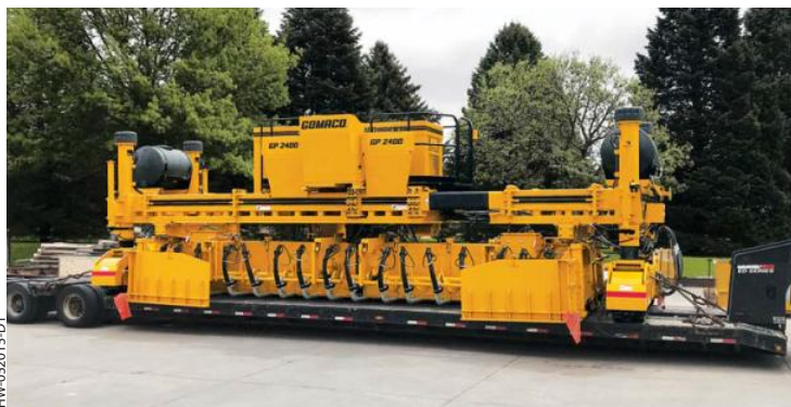
2トラックGP-2400は、最小回送幅と現場間の移動が容易になるように設計されました。
