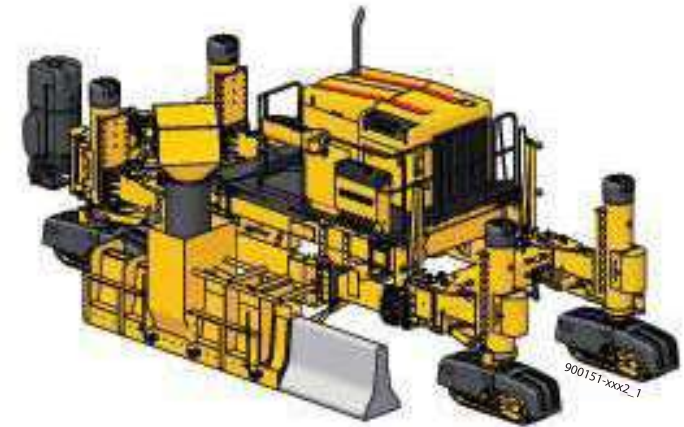
防護柵や欄干打設用の4トラックペービングパッケージ、回送時
