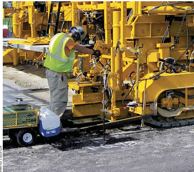
GOMACOのサイドプレートエクステンションと油圧システム バーインサーター
