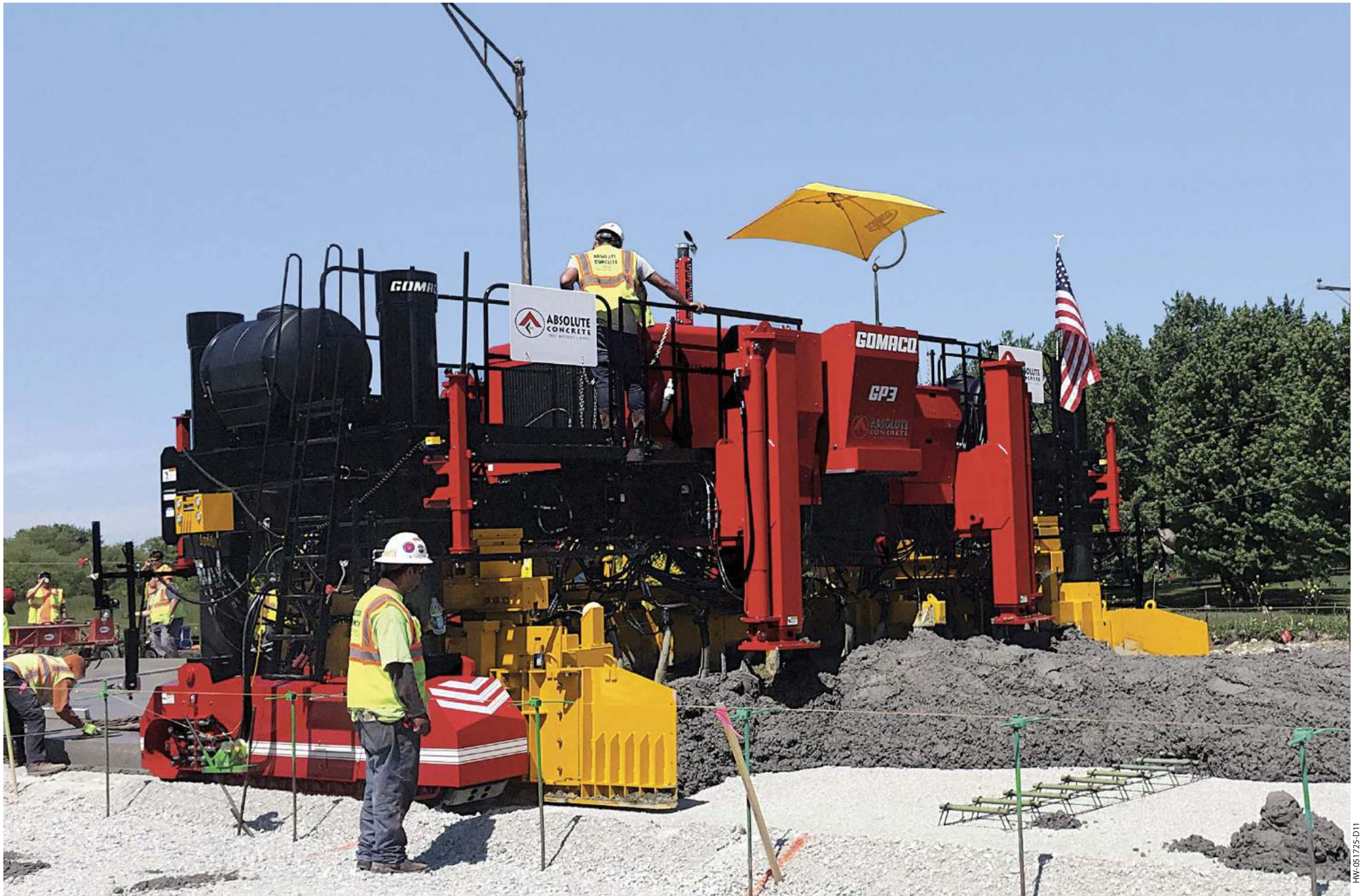
2トラックGP3は、回送積み込み時やフレーム幅の変更時にアウトリガーを装備することができます。アウトリガーを追加することで、GP3を上昇させ、トラックトレーラーをマシンの下に後進させることができます。
