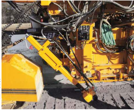
4トラックペーパーの油圧式バーインサーターは、モールドの端、リアレッグの前に配置されます。
