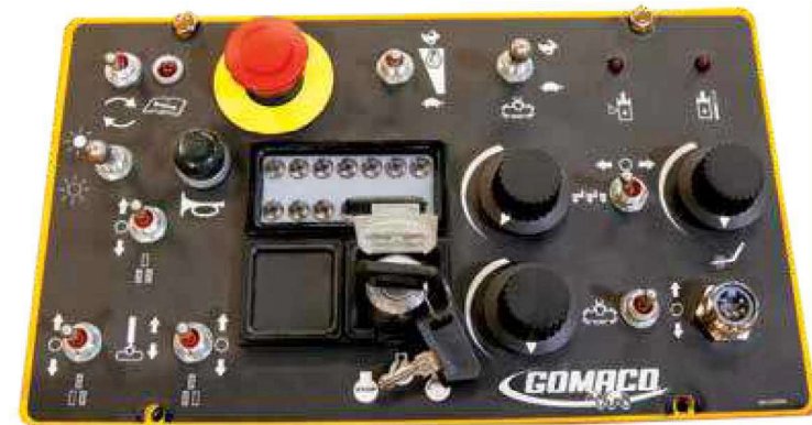
走行、グレード、パイブレータ、オーガの各制御は各ハンドル上に設置されています。
