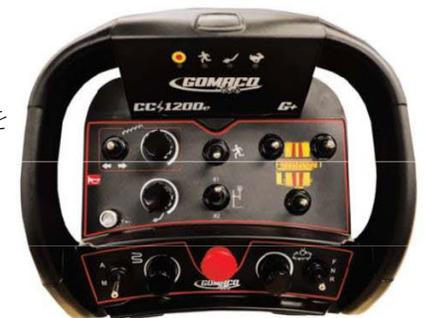
CC-1200e の無線遠隔制御は、作業現場での移動中にオペレーターの完全なマシン操作を実現します。
