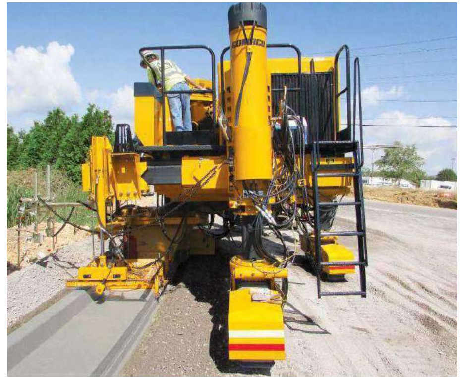
コマンダーIIIのインテリジェント・オールトラック・ポジショニング(ATP)は、3脚のレッグにそれぞれスマート油圧シリンダーを含みます。各トラックの位置関係を把握し、必要に応じてステアリングの調整を行います。
