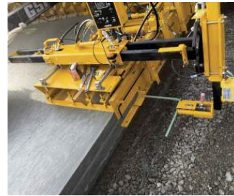
2トラック用の油圧式バーインサターは、モールドとトラックの後方に配置されます。
