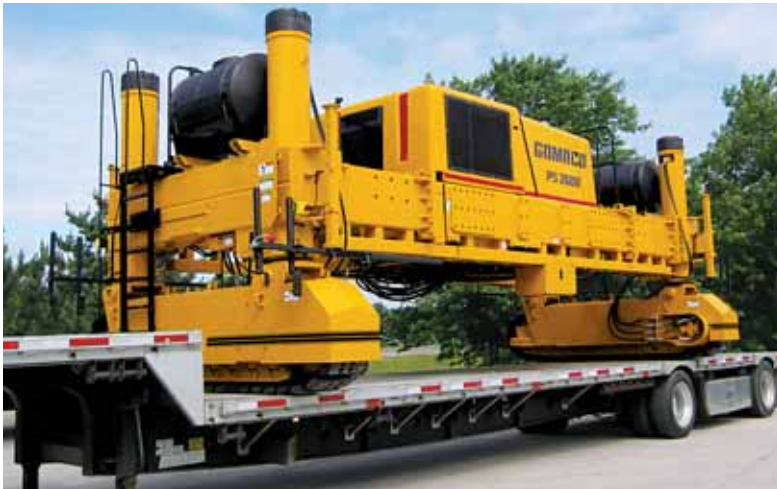
PS-2600のストライクオフモールドを装着していない状態での回送時の最小幅は、12フィート(3.66 m)、高さは9.75フィート(2.97 m)です。また、12フィート(3.66 m)のストライクオフモールドを取り付けた状態で、回送時の最小の長さは19フィート(5.97 m)です。
