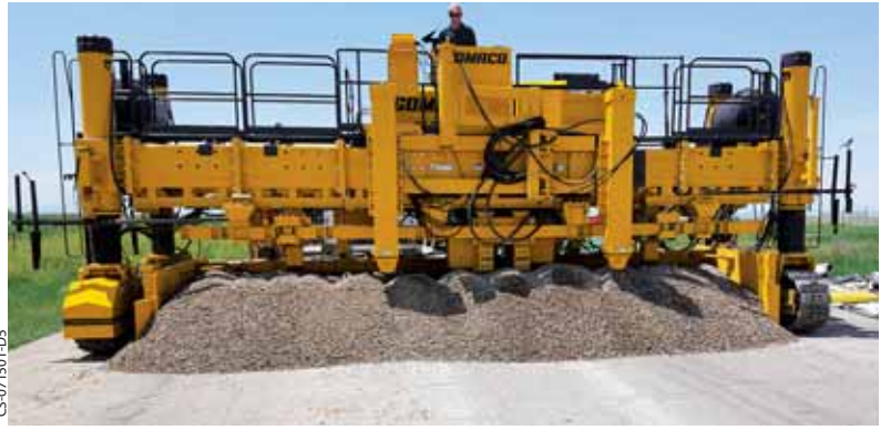
7500シリーズプレーサモールドを装備したこのPS-2600は、石を配置しています。オーガの直径は24インチ(610mm)です。
