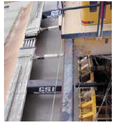
GHP-2800に搭載されたGSIユニットが米国インディアナ州の新しいインターステート 69をプロファイル。
