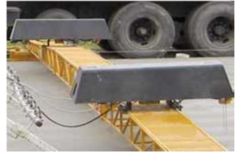
GSIユニットはGOMACOスパニット・ワークブリッジに搭載可能です。これらの写真ではワークブリッジはGOMACO GHP-2800スリップフォーム・ペーパーの後に取付けられています。
