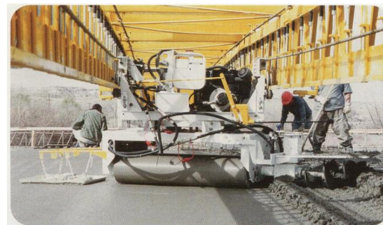
GOMACO 社の特許・3点式仕上げシステム
